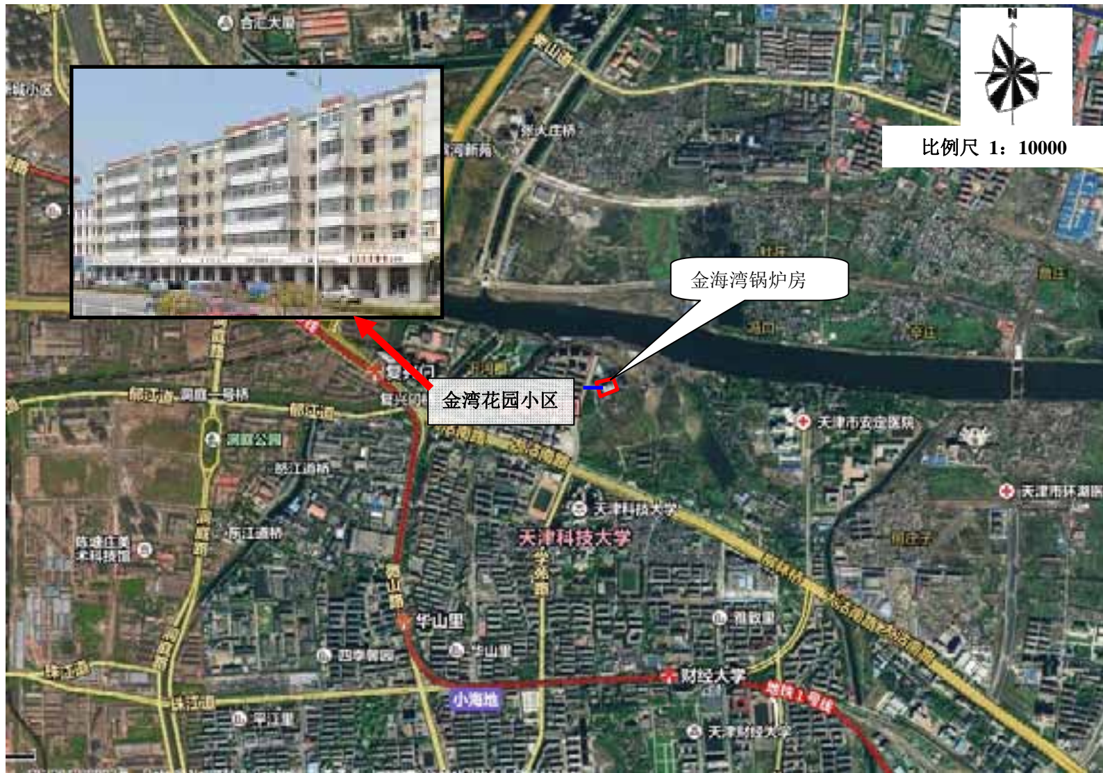
附图 2-4-10 金海湾锅炉房涉及管网路由图
