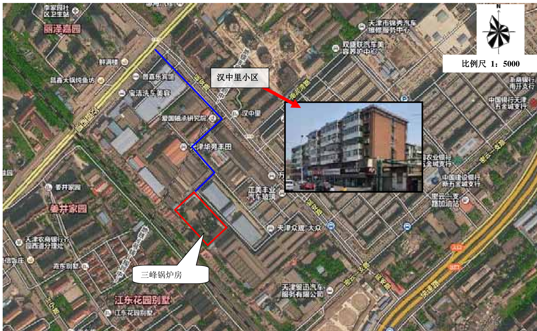
附图 2-3-3 三峰锅炉房涉及管网路由图
