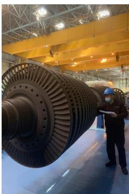
陈塘热电公司一套机组扩大性检修，生技部机务专业工程师顾大雪查验汽轮机高中压缸转子
