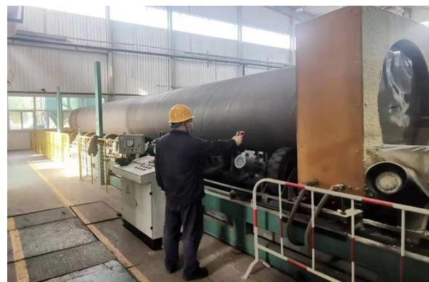
津能管业工作人员李文星检测车间钢管温度
