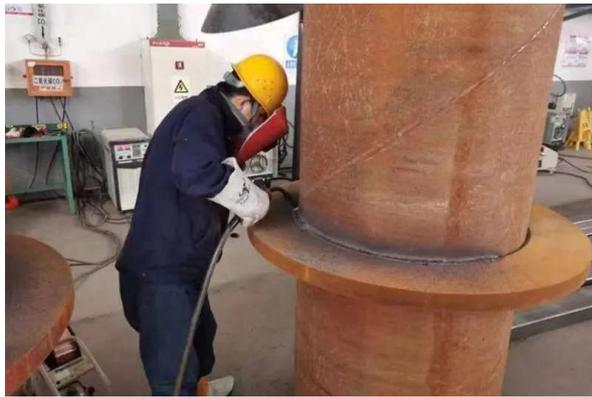
津能管业公司钢焊组工作人员宫志勇焊接 DN500 固定节
