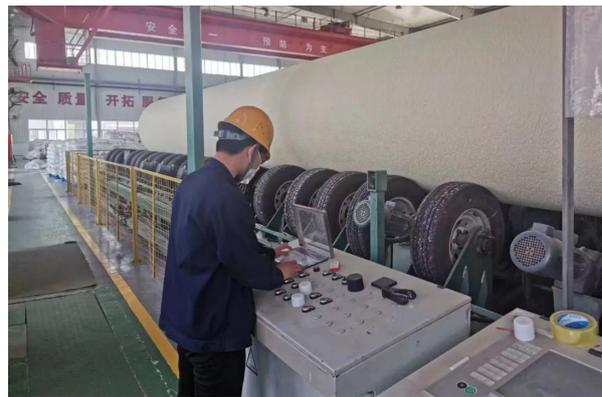
津能管业公司工作人员戴一鸣调整缠绕保温管行进速度
